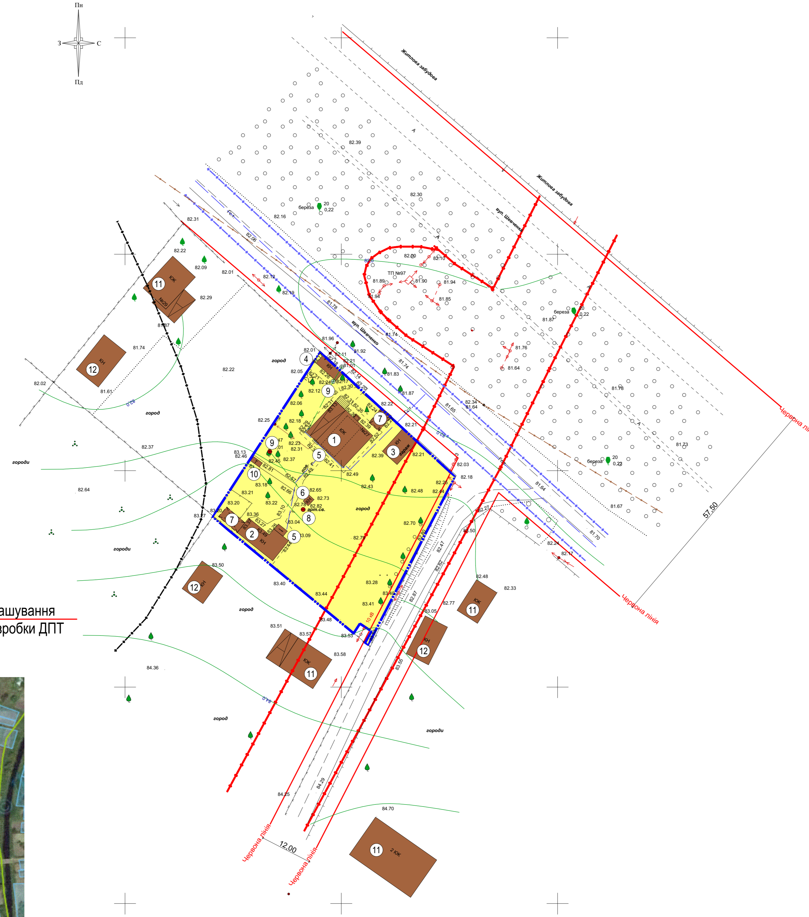
ОПОРНИЙ ПЛАН. ПЛАН ІСНУЮЧОГО ВИКОРИСТАННЯ ТЕРИТОРІЇ. СХЕМА ІСНУЮЧИХ ПЛАНУВАЛЬНИХ ОБМЕЖЕНЬ М 1:500
